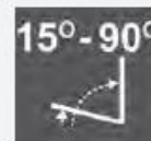
INCLINAÇÃO DO TELHADO
