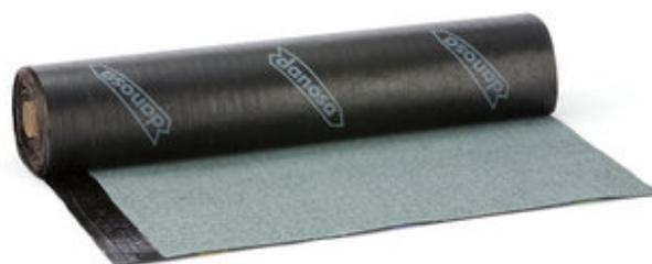
O ESTERDAN PLUS 40/GP ELAST. é uma membrana impermeabilizante betuminosa de superfície auto-protegida de 4.0 kg/m<sup>2</sup>. É composta por uma armadura de feltro de poliéster reforçado, recoberta nas duas faces com um mástico de betume modificado com elastómeros (SBS), usando como material de protecção na face externa da membrana, ardósia. Como material anti-aderente, na face interna usa-se um filme plástico.
