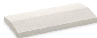
Los Cubremuros Albardilla tienen un diseño de doble pendiente que ayuda a mantener los muros limpios y secos con gran facilidad. Los Cubremuros SAS disponen de goterón y de ranuras en la parte inferior que permiten una mejor fijación con el muro. Nuestros Cubremuros se fabrican en dos tipos de acabado: "Dry-Cast" acabado piedra o "Wet-Cast" acabado liso.
