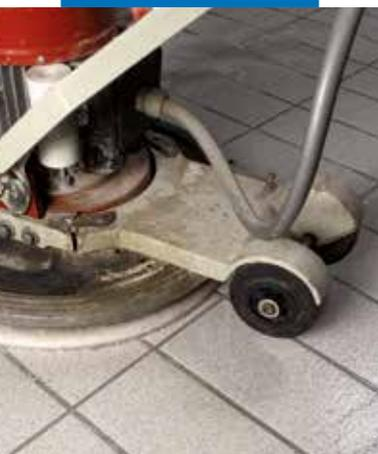
Limpeza com água utilizando uma máquina a mono-disco rotativa equipada com discos em feltro abrasivo tipo "Scotch-Brite"
